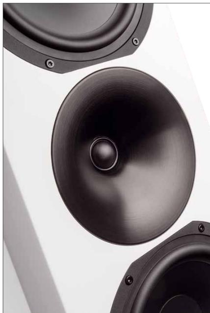
Die 28-mm-Kalotte des Hochtöners sitzt hinter einem großen Wellenleiter, der für mehr Wirkungsgrad und eine Optimierung des Abstrahlverhaltens sorgt
